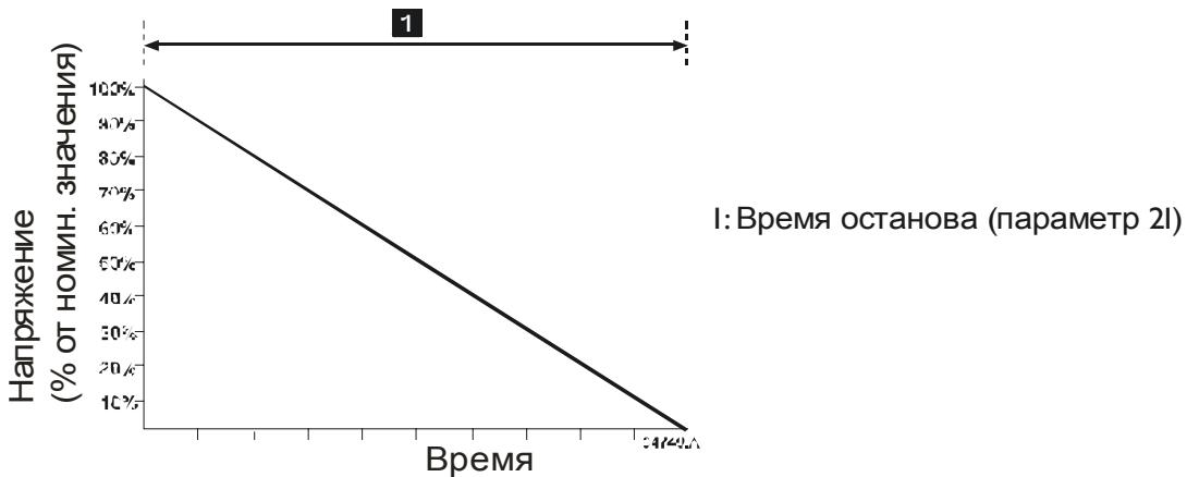
Плавный останов со снижением напряжения используется в случаях, где необходимо увеличить время останова, например, чтобы плавно снять нагрузку с питающего электрогенератора.
