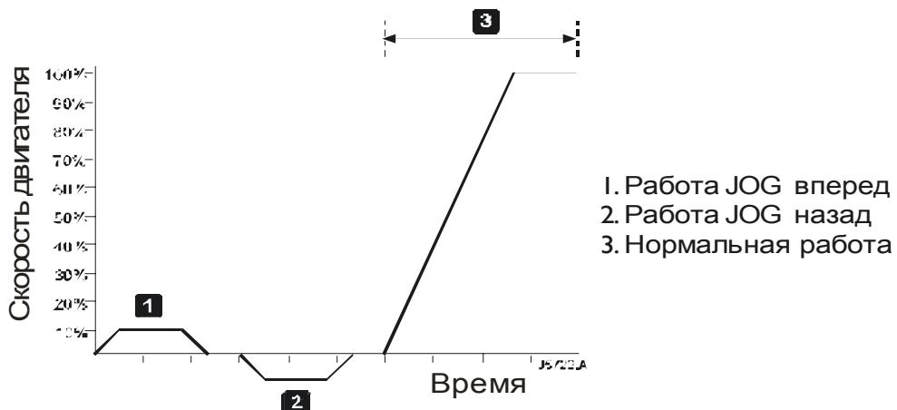
В некоторых применениях момента, развиваемого двигателем в режиме JOG, может оказаться недостаточно для обеспечения вращения двигателя. В таких случаях можно использовать дополнительную настройку для второго двигателя (группа параметров 10). Смотрите также описание примера применения «Работа в режиме JOG с EMX3» (710-06355-00).
