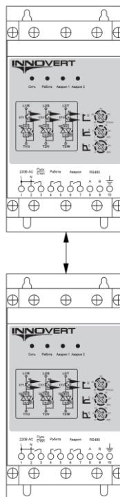
3) При установке двух или более устройств плавного пуска горизонтально друг от друга, расстояние между ними должно составлять не менее 50 мм.
