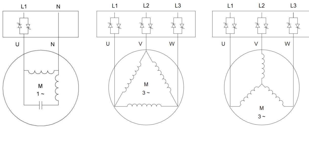
Схемы подключения обмоток электродвигателя: а) для однофазных, с рабочим конденсатором
