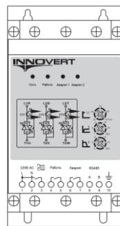
2) При установке двух или более устройств плавного пуска вертикально друг от друга, расстояние между ними должно составлять не менее 100 мм.
