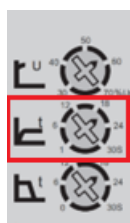
Рис.7 Потенциометры на панели управления УПП INNOVERT SSD, средний потенциометр отвечает за разгон электродвигателя
